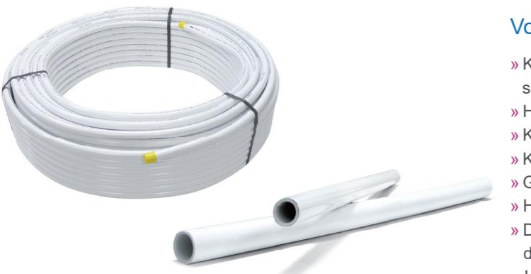
Das Aluminium-Mehrschichtverbundrohr ist ein fünf-schichtiges Kunststoff-Metall-Verbundrohr für Sanitär- und Heizungsanwendungen. Es hält einer Dauertemperatur von 70 °C und einem Maximaldruck von 10 bar über 50 Jahre stand. Die zulässige maximale Betriebstemperatur beträgt 95°C für max. 1 Jahr.
