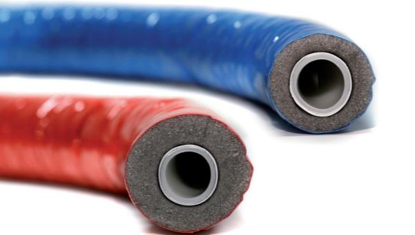
Das vorgedämmte Aluminium-Mehrschichtverbundrohr ist ein fünf-schichtiges Kunststoff-Metall-Verbundrohr für Sanitär- und Heizungsanwendungen mit vorgefertigter Kälte- / Wärmedämmung aus thermogeschweißtem, extrudiertem PE-Schaum sowie mit einer Schutzschicht aus PE-Folie.
